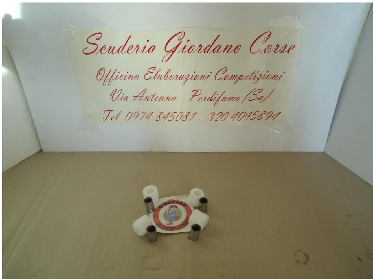
4 boccole in tecnoplastica triangoli ant inferiore
