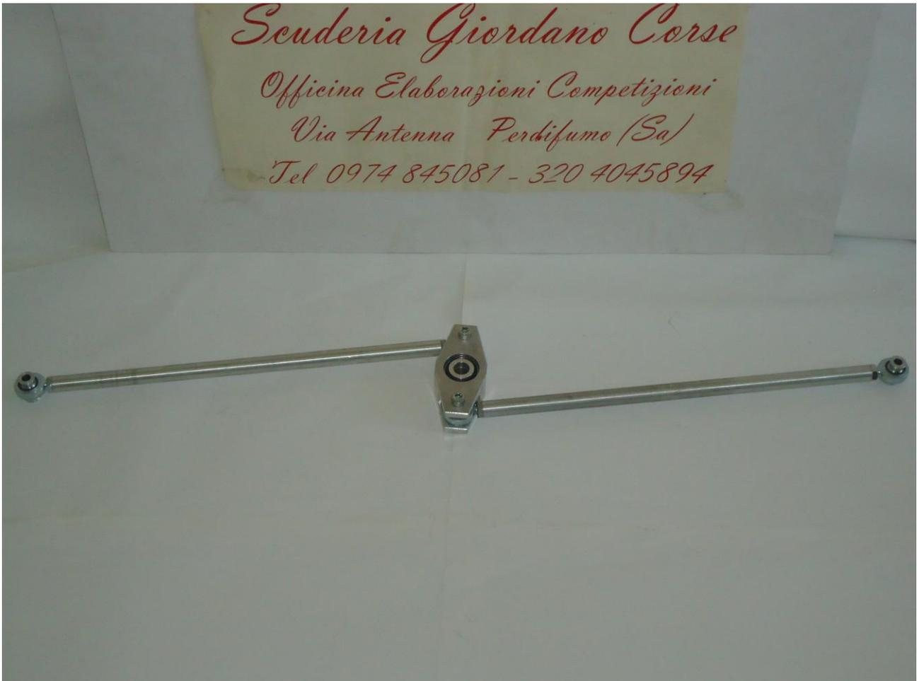
Kit leveraggio Di Watt in alluminio regolabili su unibal e Snodo centrale in alluminio su cuscinetto
